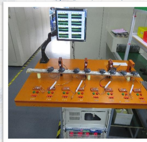
風扇電測設備
